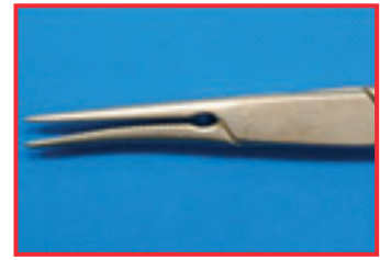
Verformung durch unsachgemäße Handhabung
