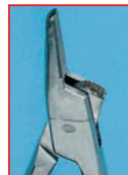
Maulbruch Hartmetallnadelhalter
