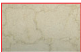
Fleckenmuster durch Verunreinigungen im Dampfcondensat
