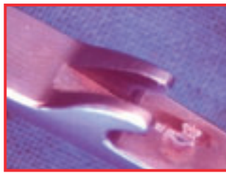
Branche Nadelhalter mit Reibstelle durch Feder
