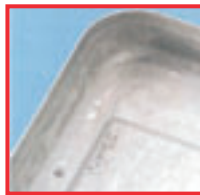
Materialangriff Grund: Behandlung mit alkalischem Reiniger
