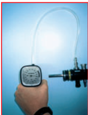
Manueller Dichtigkeitstest bei einem flexiblen Endoskop
