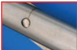
Haarriss im Gewindebereich einer Schere
