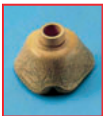
Alterungsriß an einer Atemmaske
