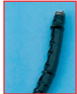
Aufquellung am Distalende eines Fiberskops
