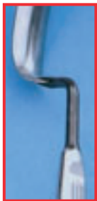
Wundhaken mit Chrom-nickelstahlkomponente und verfärbtem Chromstahl
