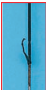
Beschädigte Isolierung an einem HF-Instrument
