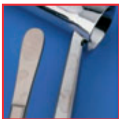
Verfleckungen auf Grund hohen Salzgehalts im Abspülwasser
