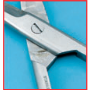
Reibkorrosion infolge fehlender Pflege mit Öl
