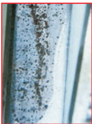
Ablagerungen eines chloridhaltigen Ätzmittels auf einem Instrument
