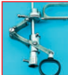
Materialangriff nur an den Aluminium-Komponenten. Grund: Behandlung mit stark alkalischem Reiniger
