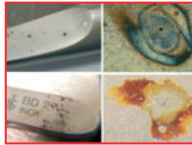
Beispiele für Lochkorrosion
