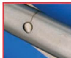
Anriss am Schraubengewinde
