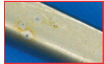
Chloridinduzierte Lochkorrosion auf dem Instrument
