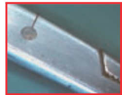
Anriss am Gelenkniet
