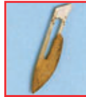
Rost an einer Skalpellklinge Grund: Werkstoffauswahl, kein NR-Stahl da Einwegprodukt
