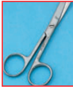
Schere mit Lochkorrosion
