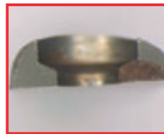
Bruchfläche in der Bohrungssenkung für Schraubenkopf
