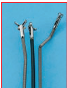
Gewaltsam beschädigte Biopsiezangen
